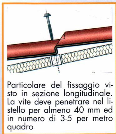
Particolare del fissaggio visto in sezione longitudinale. La vite deve penetrare nel listello per almeno 40 mm ed in numero di 3-5 per metro quadro
